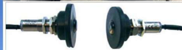
Foto 1. Fotoemisior y fotosensor integrado en el conducto de canjilones para cuantificar el flujo de cosecha.
